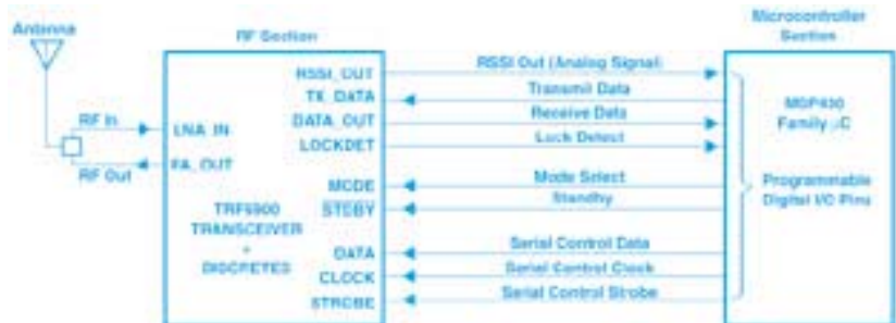
Рис. 1. Включение приемопередатчика TRF6900 с микроконтроллером MSP430
